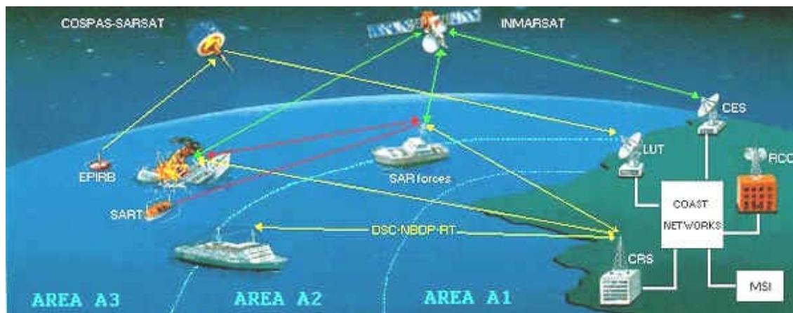
Figur 4, På illustrationen ser vi at et nødstedt skib i område A3 der udsender et nødsignal. Dette signal bliver udsendt fra tre steder; fra selve skibe, fra en redningsflåde (SART – Search and Rescue Radar Transponder) og fra en lille nødbøje (EPIRB – Emergency Position Indicating Radio Beacon). Skibet og redningsflåden sender direkte til de omkringliggende skibe, der også kontakter kyststationen på land (RCC – Rescue Coordination Center) hvorfra indsatsen bliver koordineret. EPIRB senderen, men også det havarerende skib sender automatisk et nødsignal med position til nærmeste satellit, og derfra videre til RCC. GMDSS sikrer dermed en langt hurtigere og bedre koordineret redningsindsats. Ordforklaringer: LUT - Local User Terminal, CES – Coast Earth Stations, CRS – Coast Radio Stations og MSI – Maritime Mobile Service Identity.
